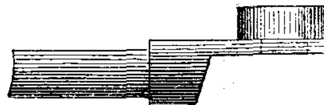
1062. Наконечникъ вилки, штампованный.
